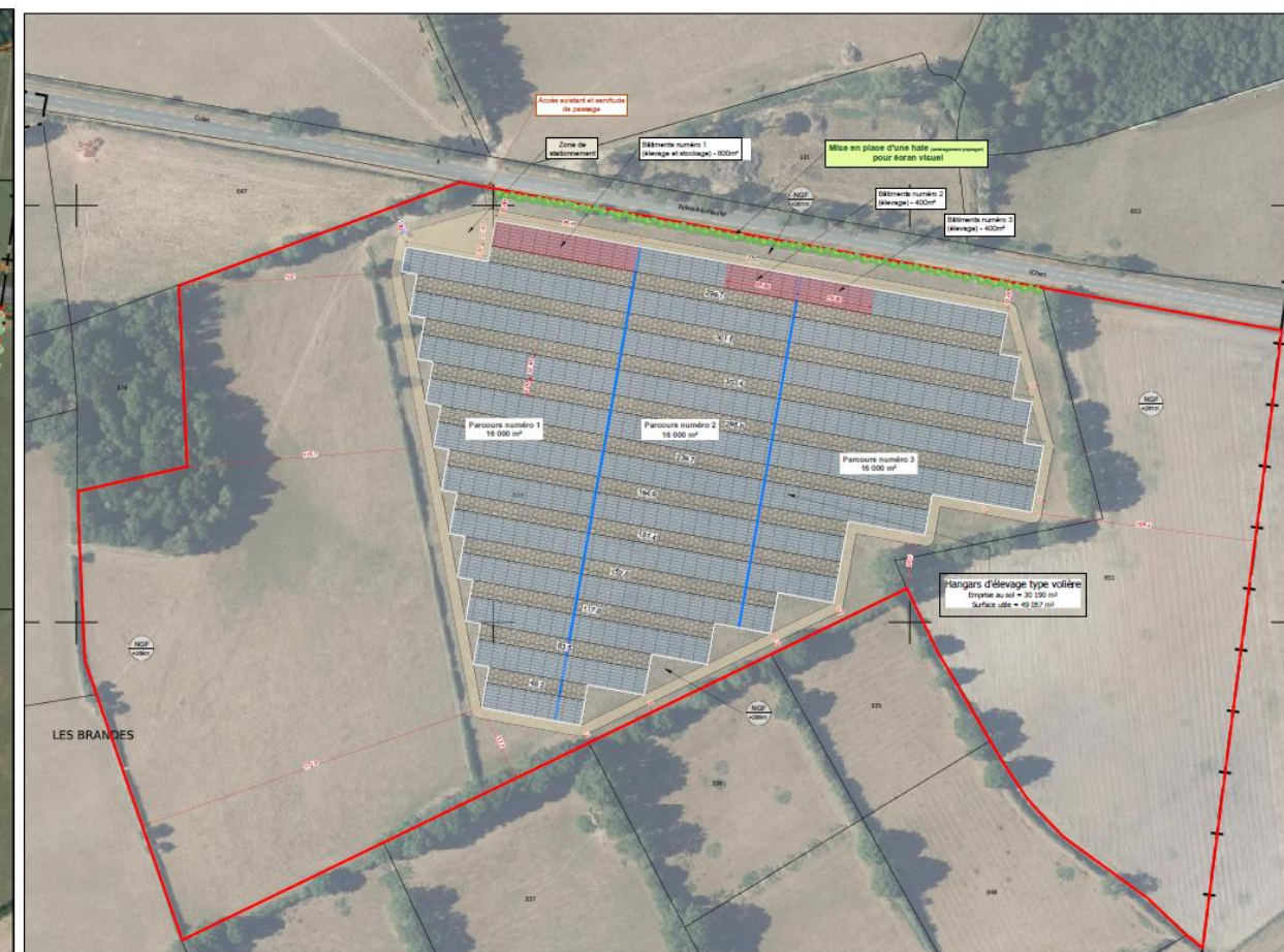
Figure 6 : Plan de masse du projet après révision de l'implantation (6,5 MWc)
