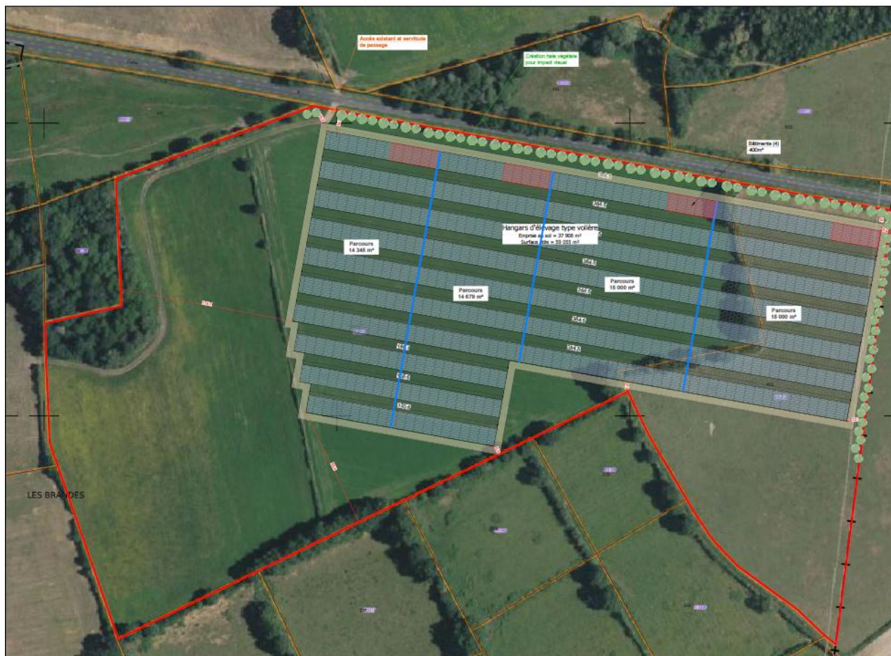
Figure 5 : Plan de masse du projet avant révision de l'implantation (8,5 MWc)
